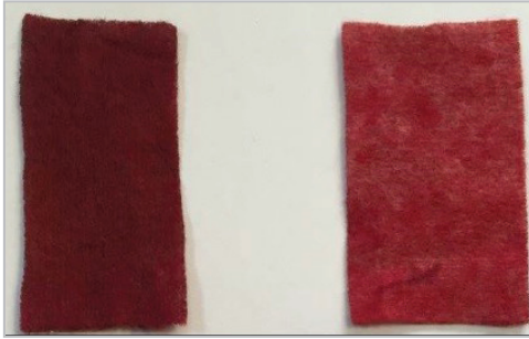
شکل ۵- پد بدون دندریمر (سمت راست) و پد حاوی دندریمر (سمت چپ) بعد از غوطه‌وری در محلول شبیه‌ساز خون
